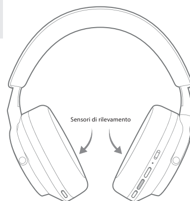
Diagramma 3 Ubicazione del sensore di rilevamento
