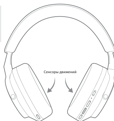
Diagram 3 Расположение сенсоров приближения
